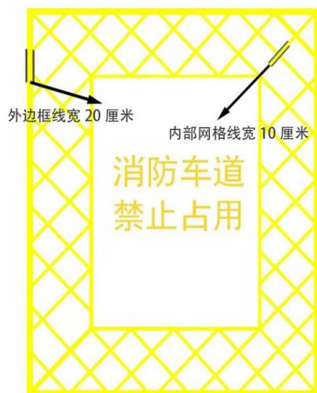
图 2 消防车通道出入口禁停标线及路面警示标志
